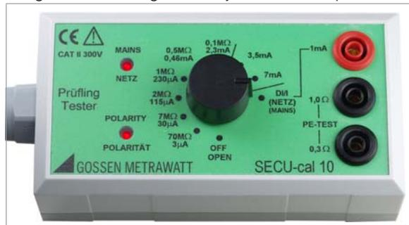
Es sind dabei alle Grenzwerte für die geforderten Prüfungen nach DIN VDE wie Schutzleiterwiderstand, Isolationswiderstand, Ersatzableitstrom, Differenz- und/oder Berühr- bzw. Gehäuseableitstrom zu überprüfen.
