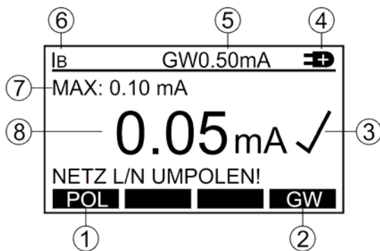
Abb. 24: Anzeige bei der Berührungstrommessung I_B (Beispiel)
