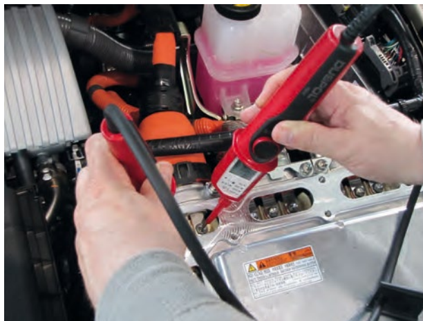
Prüfung der hohen DC-Spannung eines HV-Elektrofahrzeuges
