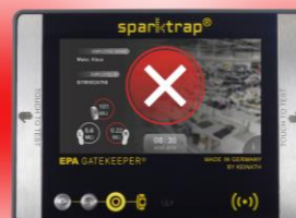
Rote Signalisierung bei „schlecht“ Messung
