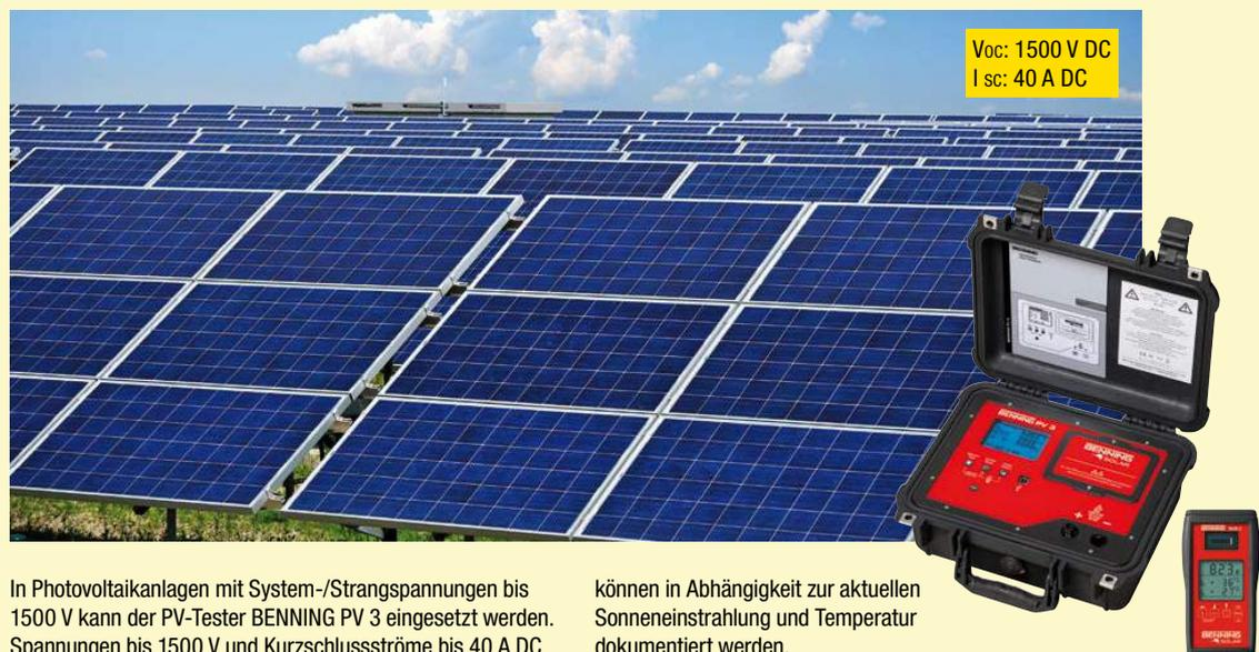
In Photovoltaikanlagen mit System-/Strangspannungen bis 1500 V kann der PV-Tester BENNING PV 3 eingesetzt werden. Spannungen bis 1500 V und Kurzschlussströme bis 40 A DC
