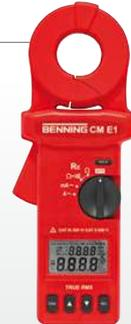
Erdungsmesszange zur schnellen, sicheren und spießlosen Messung des Erdungswiderstandes
