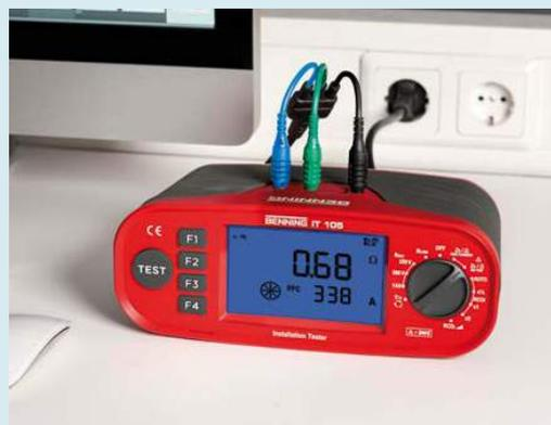
Das Niederohm- und Isolationswiderstands-Multimeter BENNING IT 108 wird genutzt bei der Fehlersuche und Fehleranalyse in elektrischen Systemen jeder Art. Vielfach wird es zur Ausstattung von Servicespezialisten in der Industrie- und modernen Fahrzeugtechnik genutzt.
