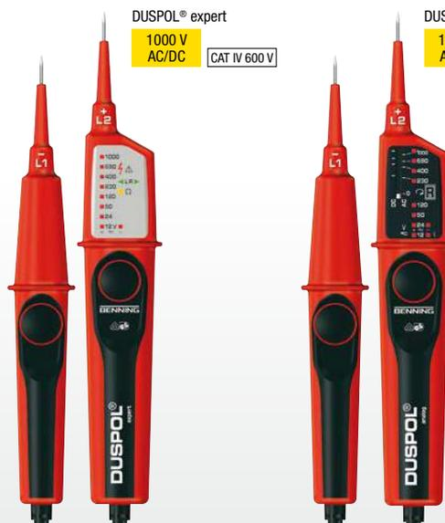
Alle DUSPOL®-Spannungsprüfer besitzen ein direktes Anzeigesystem mit geringer Belastung der Prüfstelle. Im Bedarfsfall kann ein Lastkreis über Drucktaster zugeschaltet werden, der induktive und kapazitive „Blindspannungen“ unterdrückt. Somit kann eindeutig zwischen energiereichen und energiearmen Stromkreisen unterschieden werden.
