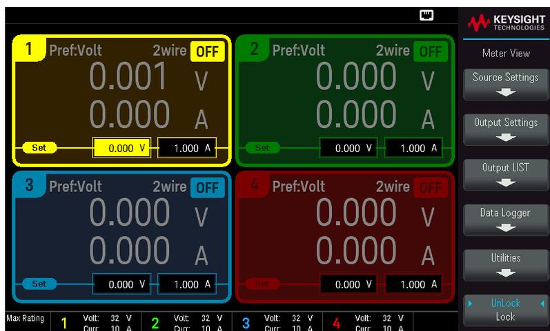
Appuyez sur une des quatre touches [On] pour activer une sortie individuelle. En mode Meter View, l'alimentation mesure en continu et affiche la tension et l'intensité de sortie de chaque sortie.
