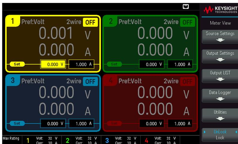
Enfin, appuyez ensuite sur la touche **Source Settings** pour accéder à la fenêtre des paramètres de source. Utilisez les touches de navigation pour mettre en surbrillance les champs Voltage ou Current . Saisissez ensuite les valeurs de tension et d'intensité à l'aide du clavier numérique.
