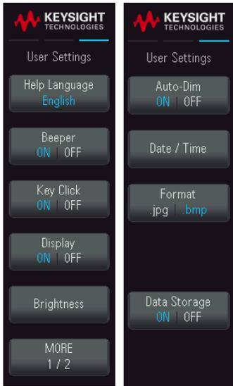
**User Settings** indique les préférences de l'utilisateur qui contrôlent la façon dont l'utilisateur interagit avec l'instrument. Les paramètres sont enregistrés en mémoire non volatile.
