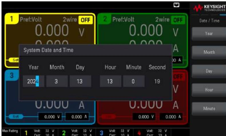
**Date / Time** règle l'horloge en temps réel de l'instrument, qui utilise toujours un format de 24 heures (00:00:00 à 23:59:59). Il n'y a aucun réglage automatique de la date et de l'heure, de manière à régler à l'heure d'été.
