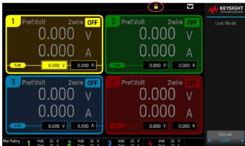
2. Sélectionnez **Unlock** pour déverrouiller le panneau avant.
