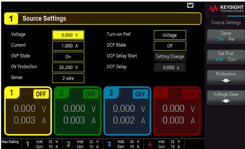
Le tableau ci-dessous indique la plage de sortie et la valeur par défaut pour les réglages de la tension et du courant.
