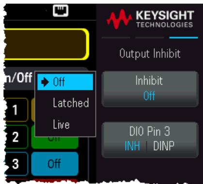
Pour effacer la fonction de protection d'inhibition, éliminez d'abord le signal d'inhibition externe. Puis, sélectionnez **Source Settings > Protection > Protection Clear** pour toutes les sorties. Ceci désactive la fonction de protection d'inhibition et restaure la sortie à son état de fonctionnement antérieur.
