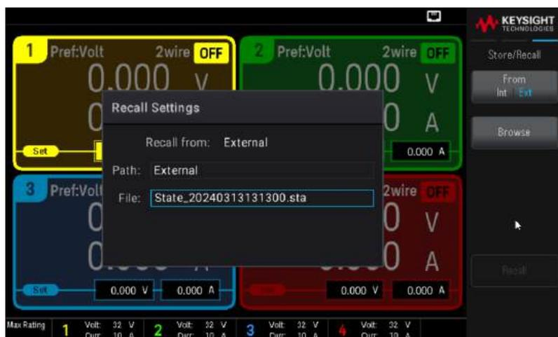
Source [Int](#) | [Ext](#) rappelle l'état de l'instrument dans un disque flash USB externe raccordé.
