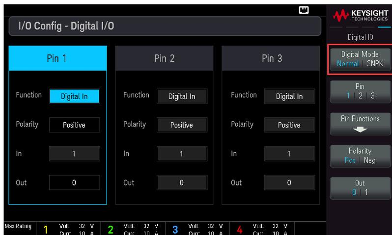
Le **Digital Mode** permet de basculer entre le mode **Normal** et **SNPK** (Kit Série et Parallèle).
