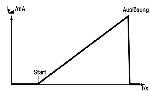
In der Schalterstellung  $I_F$  fließt ein langsam ansteigender Gleichstrom über N und PE. Der aktuelle Strommesswert wird hierbei ständig angezeigt. Bei Auslösung des RCD-Schalters
