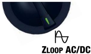
**Tritt während dieser Messung eine gefährliche Berührungsspannung (> U<sub>L</sub>) auf, dann erfolgt eine Sicherheitsabschaltung.**
