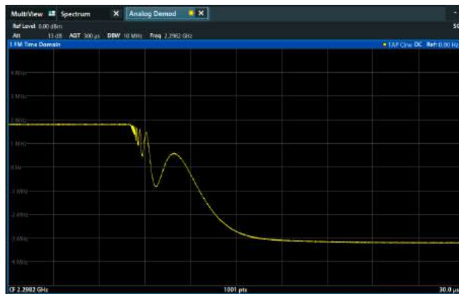
Frequenzeinschwingzeit eines Oszillators
