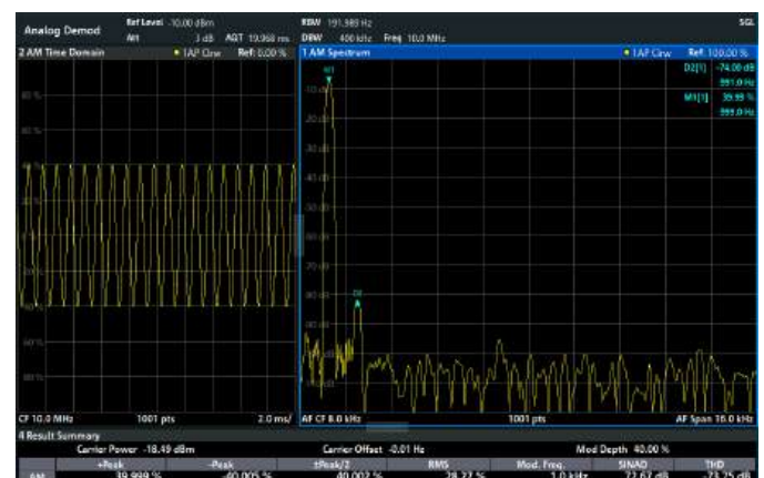
Klirrfaktormessung an einem amplitudenmodulierten Signal: erste Oberwelle des Modulationssignals ist mit 74 dB gut unterdrückt
