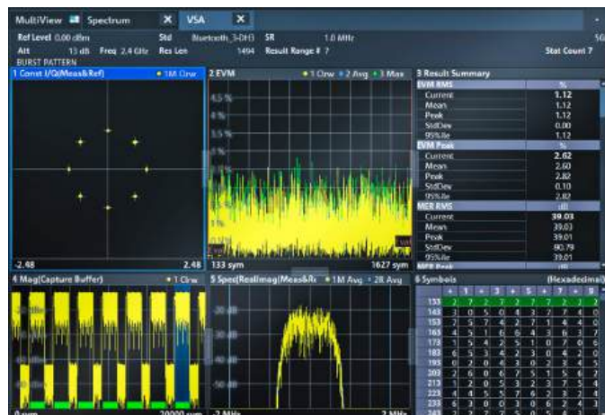
Demodulation eines Bluetooth® Signals mit der R&S®FPL1-K70 Option
