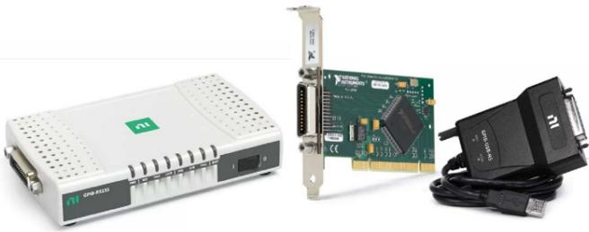
Die Systemintegration von Messgeräten erfolgt über eine GPIB-Schnittstelle. Geräte zur Messgerätsteuerung über GPIB umfassen IEEE-488-Controller, die mit ExpressCard, PMC, PCMCIA, PCIe, PCI und USB sowie Ethernet, RS485, RS422 und RS232 kompatibel sind. Mit einigen Modellen können mehrere GPIB-Geräte gesteuert werden. Andere bieten kontinuierliche Datenübertragungsraten und keine Unterbrechungen der Übertragung durch den Mikroprozessor.
