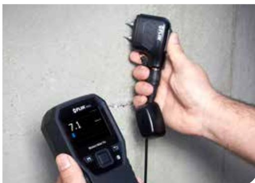
Invasive resistive Feuchtegehaltsmessungen mit dem externen Stiftsensor
