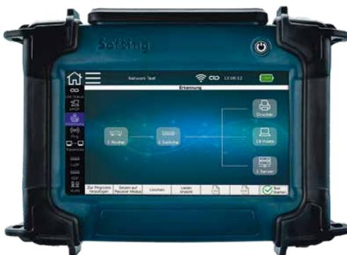
Um einen Netzwerk-Discovery-Test machen zu können, muss das Hauptgerät mit einem Switch verbunden sein
