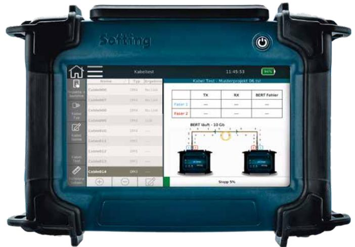
Standardkonforme Signal-/Rauschabstandsbestimmungen und Bit-Error-Rate-Tests (BERT) zeigen die Leistungsgrenzen einer Verkabelung auf, sowohl auf Kupfer-, als auch auf Glasfaser-Verkabelungen (hier abgebildet)
