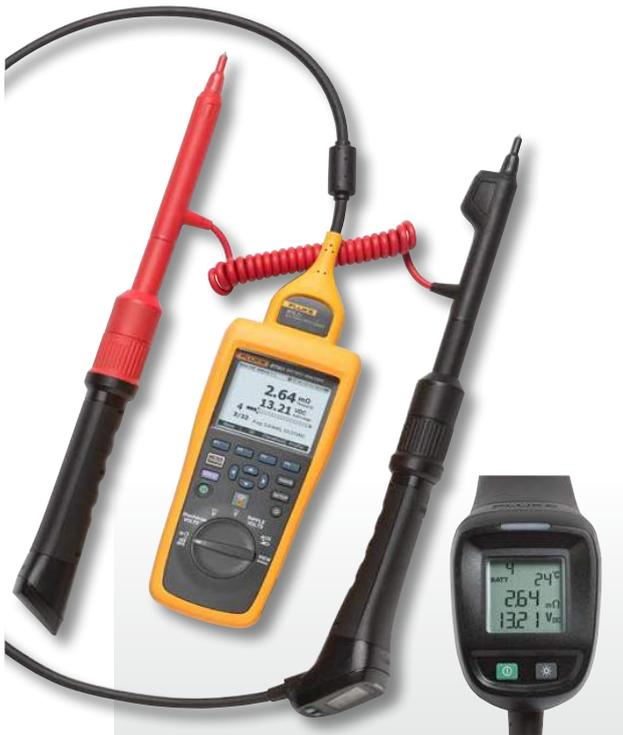
Intelligente Messsonde mit integriertem LC-Display
