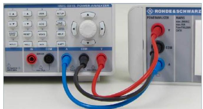
Abb. 4.6: Spannungsrichtige Messung Anschlussbeispiel
