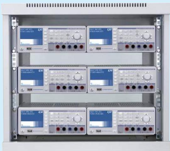
beliebig, eine ausreichende Luftzirkulation ist jedoch zu gewährleisten. Bei Dauerbetrieb ist folglich eine horizontale oder schräge Betriebslage (Aufstellfüße) zu bevorzugen.
