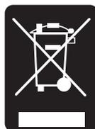
Abb. 1.4: Produktkennzeichnung nach EN 50419
