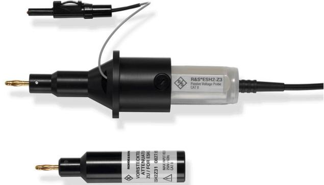
R&S®ESH2-Z3 passiver Spannungstastkopf (Mitte), Massekabel (oben) und R&S®ESH2Z31 Vorsteckteiler (unten, empfohlene Ergänzung)
