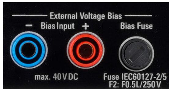
Anschlussmöglichkeit für externe Bias-Spannungen auf der Rückseite
