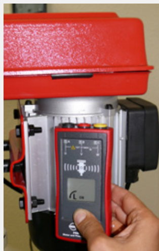
Berührungslose Motordrehrichtungsanzeige bei laufendem Motor
