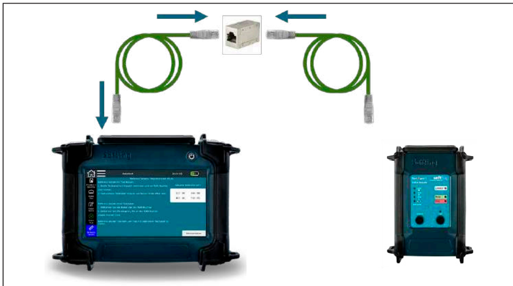
Abbildung 25 – Testaufbau zum Setzen der Referenz
