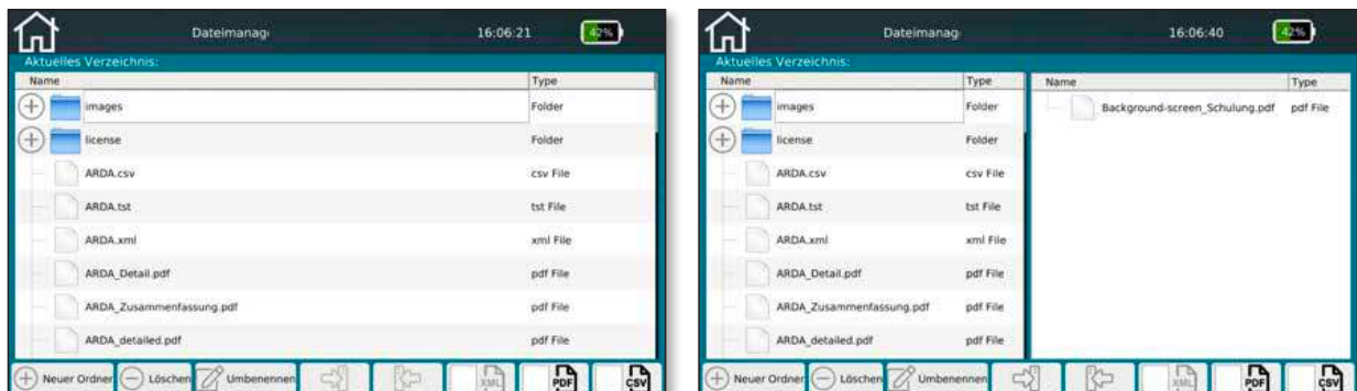
Abbildung 40 – Datei-Manager (links nur interner Speicher, rechts interner und externer Speicher bei angeschlossenem USB-Laufwerk)
