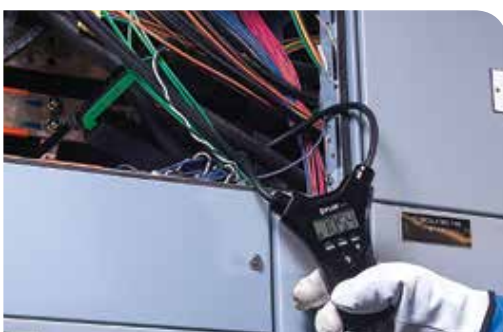
Das flexible Kabel der FLIR CM57 eignet sich ideal für beengte Platzverhältnisse
