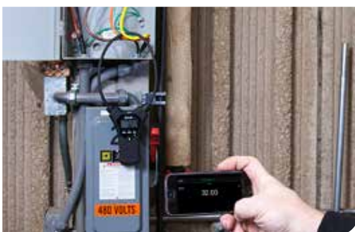
Die Bluetooth-Funktion der CM57 ermöglicht Ihnen das Ablesen von Messwerten aus sicherer Entfernung
