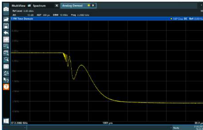
Frequenzeinschwingzeit eines Oszillators
