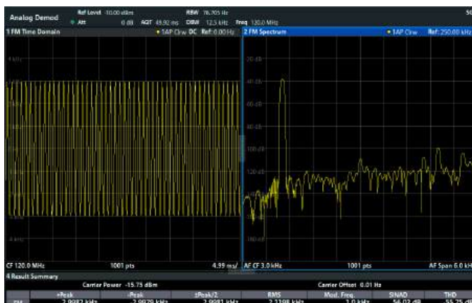
Anzeige des Modulationssignals und seines Spektrums zusammen mit Spitzen- und Effektivwert-Hub
