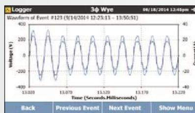
Erfassung von Spannungsereignissen und Einschaltströmen mit einstellbaren Schwellenwerten
