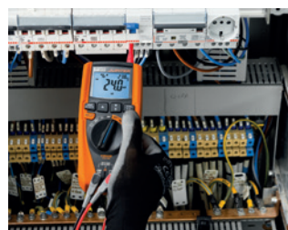
RCD Auslösezeit t_a und Auslösestrom I_a
