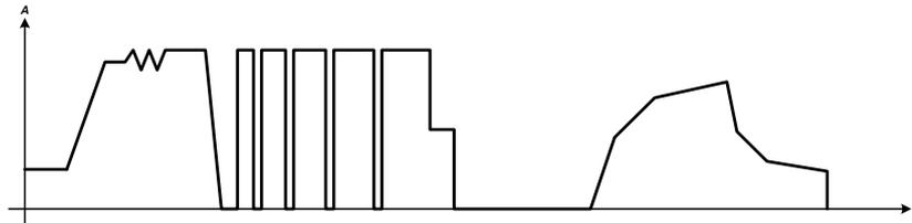
Weiterhin gibt es einen XY-Generator mit dem sich mehrere zusätzliche Funktionen realisieren lassen. Da ist zum Einen die IU-Funktion, die eine frei anwenderdefinierbare Tabelle (ladbar als CSV-Datei von USB-Stick) darstellt, und zum Anderen gibt es zwei durch anwenderdefinierbare Eckdaten generierte PV-Kennlinien, u. A. auch nach **DIN EN 50530**.
