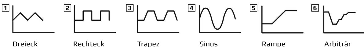
Zusätzlich zu den Standardfunktionen, die auf einem sogenannten Arbiträrgenerator basieren, ist dieser arbiträre Generator offen zugänglich, um komplexe Abläufe für z. B. Produktprüfungen aus bis zu 99 Sequenzpunkten erstellen und ablaufen lassen zu können.
