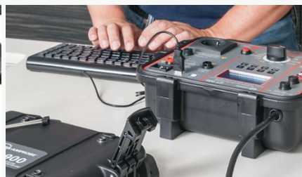
Drei separate USB-Schnittstellen zum gleichzeitigen Anschluss an PC und Eingabegeräten wie USB-Tastatur, USB-Barcodescanner, USB-Speicher oder Bluetooth Geräte mit USB-Dongle (optional)
