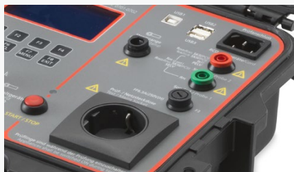
Anschluss für externen Stromzangenadapter (optional Beha-Amprobe CHB 1) zur Messung von Schutzleiterströmen auch an 3-phasigen Prüflingen (nur GT-900).
