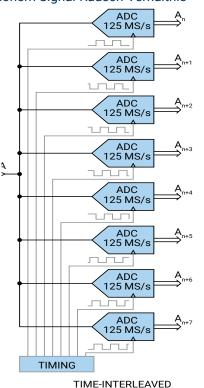
ermöglicht es die FlexRes-Technologie den Oszilloskopen der PicoScope 5000D-Serie, bei einer hohen Abtastrate Signale mit bis zu 200 MHz zu erfassen und anzuzeigen, und bei langsameren Signalen eine um das 256-fache größere Auflösung als typische 8-Bit-Oszillokope. Auflösungsanhebung – eine Technologie zur Verarbeitung digitaler Signale ist in PicoScope 6 integriert und kann den Effekt der vertikalen Auflösung des Oszilloskops auf 20 Bits erhöhen.
