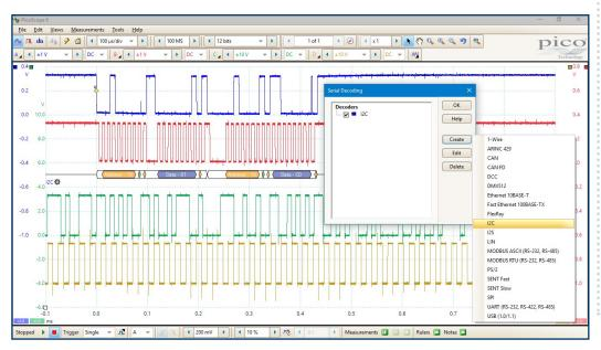
Das Grafikformat zeigt die entschlüsselten Daten (in Hex-, Binär-, Dezimalzahl oder ASCII) in einem Timing-Diagramm unter der Wellenform auf einer gemeinsamen Zeitachse an. Fehler-Frames sind rot markiert. Sie können in diese Frames hineinzoomen, um Rauschen oder Verzerrungen zu untersuchen. Jedes Paketfeld wird in einer anderen Farbe dargestellt, so können die Daten einfach ausgelesen werden.
