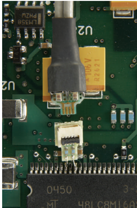
InfiniiMax ZIF tip soldered on board
