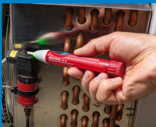
Prüfung eines Magnetventils mit BENNING VT 2
