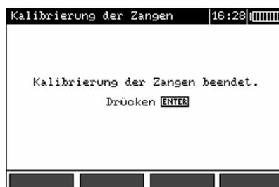
Das Messgerät bestimmt den Korrekturfaktor für die angeschlossenen Zangen. Dieser Faktor bleibt auch nach dem Ausschalten der Stromversorgung des Messgerätes gespeichert, und zwar bis zur nächsten erfolgreichen Kalibrierung der Zangen.
