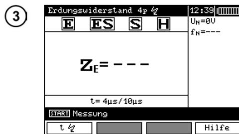
Das Messgerät ist zur Messung bereit. Auf der Hilfsanzeige kann man den Wert der Störspannung sowie ihre Frequenz ablesen. Auf dem Einstellungs balken wird die im MENÜ eingestellte Netzfrequenz gezeigt.
