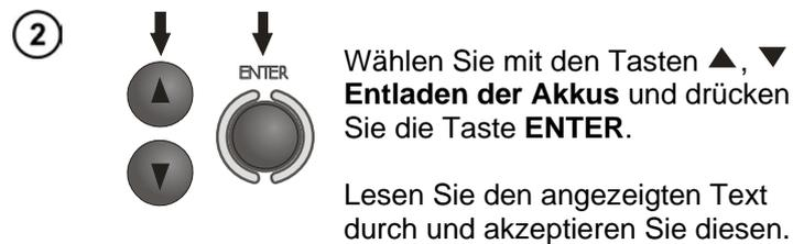
Das Entladen, das in Abhängigkeit vom Ladezustand des Pakets bis zu 10 Stunden dauert, wird mit der Aufschrift: **Verlauf des Entladeprozesses** signalisiert.
