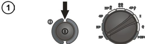
Schalten Sie das Messgerät ein. Stellen Sie den Drehschalter für die Funktionswahl auf die Position **2p**.
