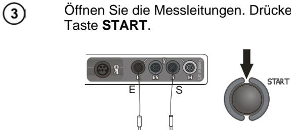
Öffnen Sie die Messleitungen. Drücken Sie die Taste **START**.
