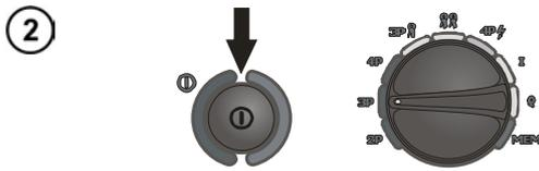
Schalten Sie das Messgerät ein. Stellen Sie den Drehschalter für die Funktionswahl auf die Position **3p**.
