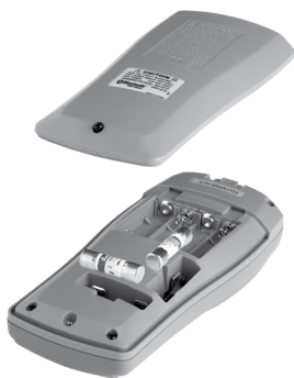
Bild 13: Sicherungswchsel Fig. 13: Fuse replacement Rys. 13: Wymiana bezpiecznika
