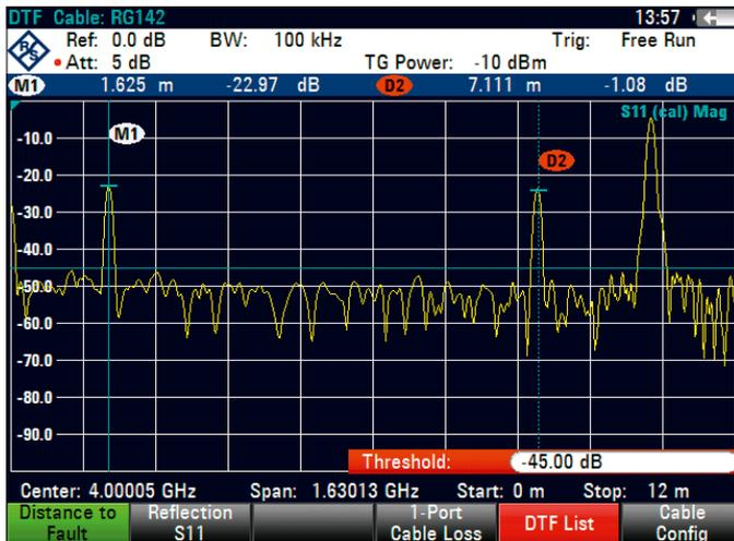
Kabelfehlstellenmessung (Distance-to-Fault, DTF)
