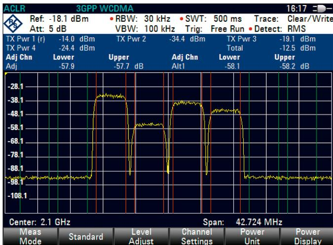
ACLR-Messung an einem 3GPP-WCDMA-Signal mit vier Trägern
