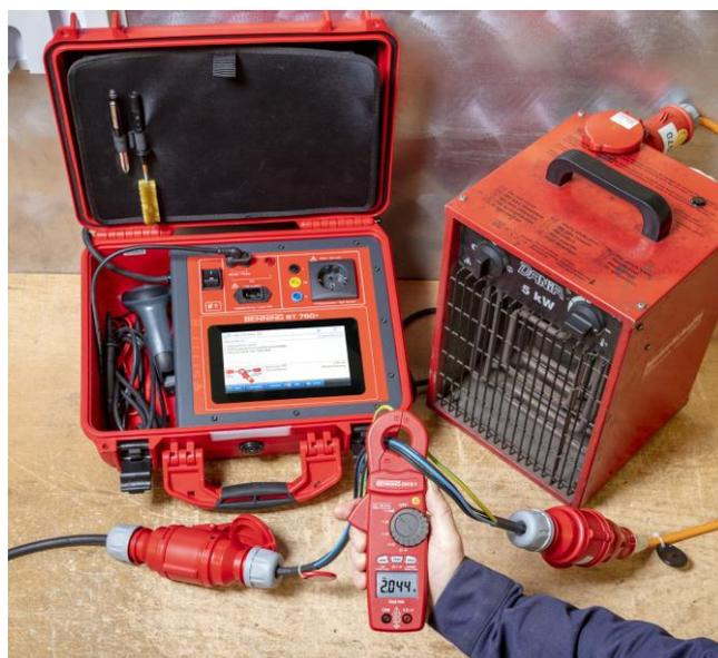
Auch die Ableitstrommessung mit einer Leckstromzange und passenden Messadaptern ist möglich. Die TRUE RMS Leckstromzangen BENNING CM 9-1 und BENNING CM 9-2, mit Messbereichen von 0,010 mA (Auflösung: 1 µA) bis 60,00 A AC, verfügen über die geforderte Abschirmung externer Magnetfelder, einen Filterfunktionen.
