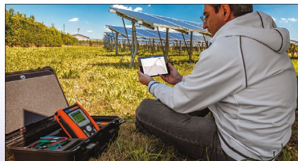
Auswertung und Protokollerstellung der U-I Kennlinie mit Ihrem Smartphone oder Tablet und der App HTANALYSIS™
