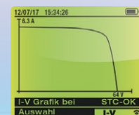
Ergebnisse können sofort grafisch als U-I Kennlinie dargestellt werden, inklusive automatischer Auswertung OK / Nicht OK
