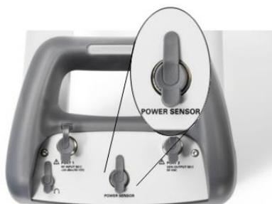
Der Anschluss ist speziell für Leistungsmessköpfe konfiguriert. Er wird sowohl zur Stromversorgung als auch für Datenübertragungen über die Schnittstelle des Leistungsmesskopfs verwendet.
