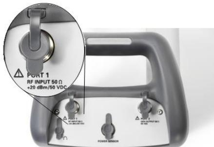
Ein Kabel oder Messobjekt wird mit einem N-Stecker an den HF-Eingang angeschlossen. Der Anschluss des Messobjekts an den R&S ZVH kann bei Bedarf über ein Kabel erfolgen.
