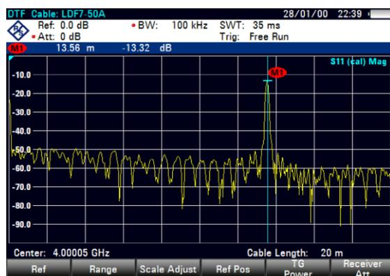
Eine blaue, vertikale Linie zeigt die Position des Markers auf der horizontalen Achse (z. B. der Frequenz).
