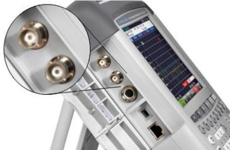
Beide BNC-Anschlüsse können für verschiedene Anwendungen konfiguriert werden. Die Namen der Anschlüsse sind auf den Innenseiten der Schutzkappen eingepreßt.
