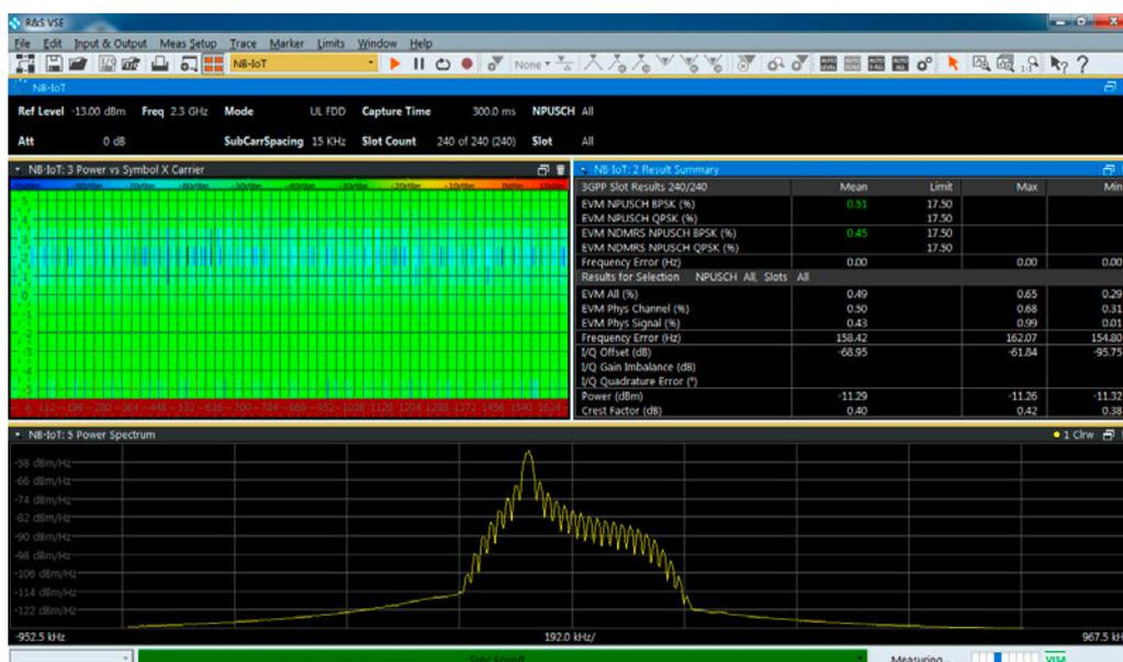
Demodulations- und EVM-Messung eines NB-IoT UL-Signals mit der R&S®VSE-K106 Messanwendung
