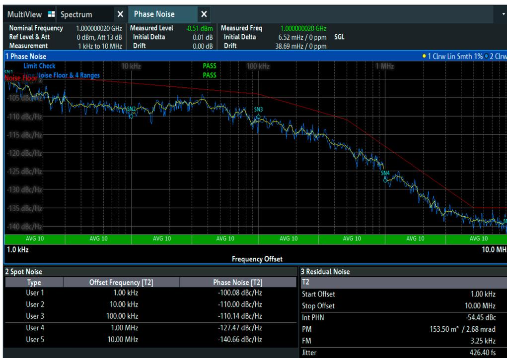
Phasenrauschmessung plus automatische Grenzwertprüfung, Anzeige von Spot-Rauschen und Restrauschen
