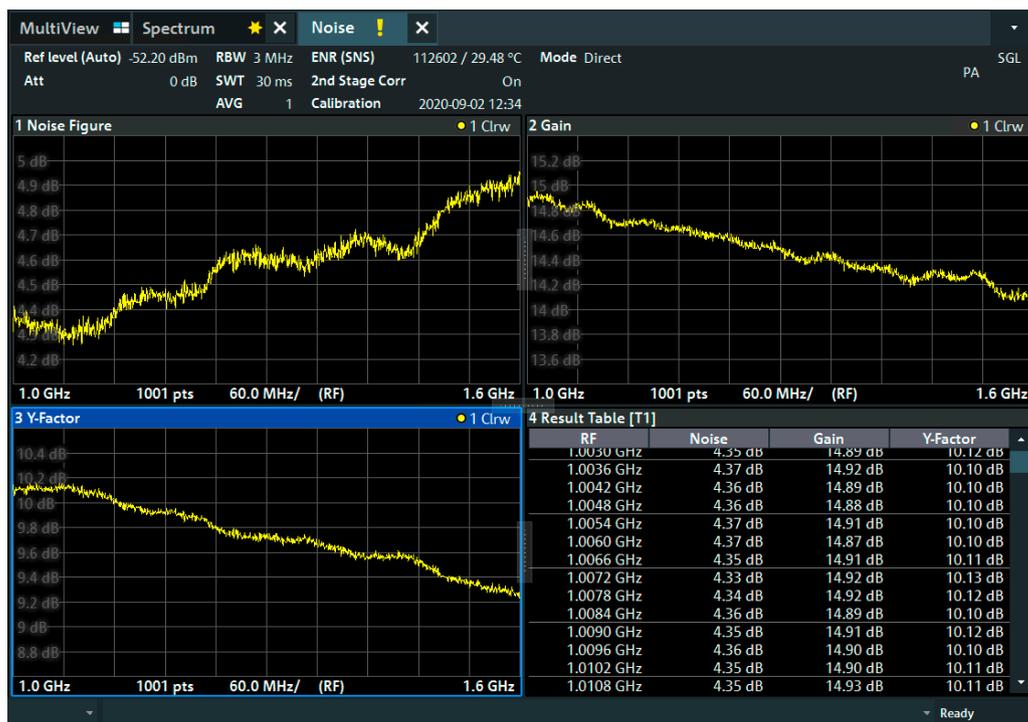
Gleichzeitige Ansicht der Diagramme für die Rauschzahl, die Verstärkung und des Y-Faktors über der Frequenz sowie eine Tabelle der Ergebnisse im numerischen Format
