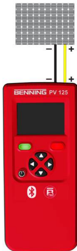
Abb. 5: Leerlaufspannungs- und Kurzschlussstrommessung
