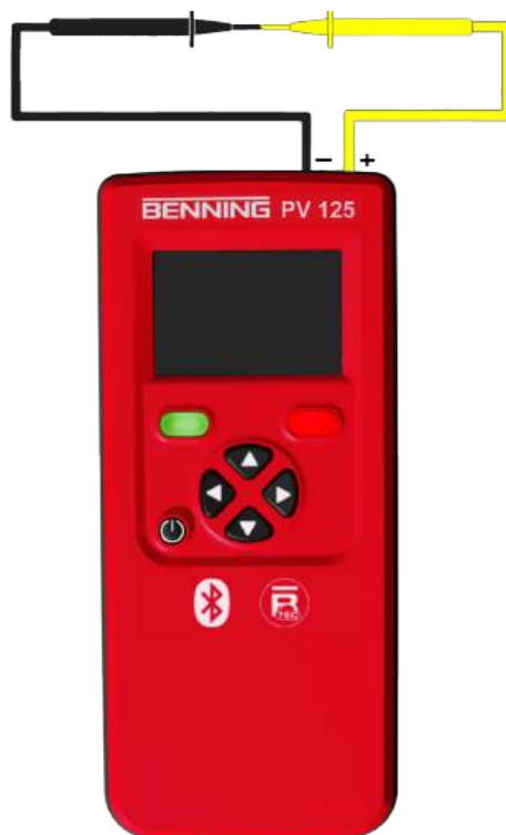
Abb. 8: Nullabgleich der 4 mm- Sicherheitsmessleitungen
