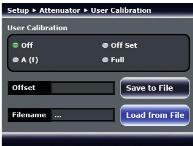
Die R&S®RSC bietet verschiedene Korrekturmöglichkeiten, z.B. Frequenzgangkorrektur oder das Einbeziehen eines Leistungsdämpfungsgliedes in die Gesamtdämpfung mittels eines konstanten Offset-Werts bzw. per File mit dessen Frequenzgang.
