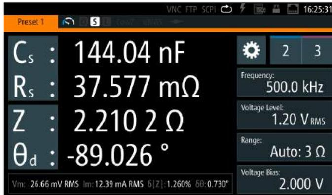
Die Messwerte werden mit bis zu 5-Stellen-Auflösung angezeigt. Bis zu vier Messwerte sind gleichzeitig darstellbar.
