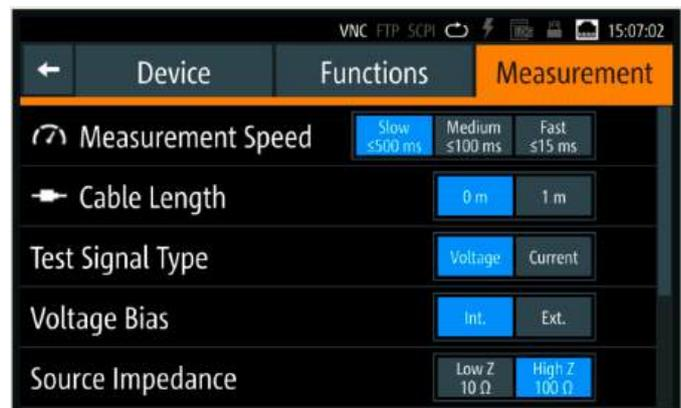
Testsignale und Messfunktionen können nach Bedarf eingestellt werden
