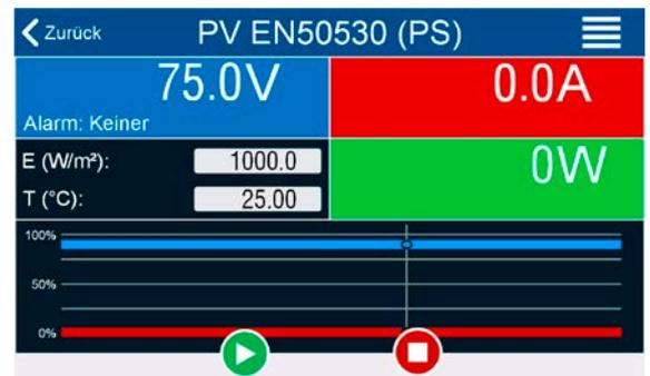
Bei einem der beiden Tagesverlauf-Modi würden hingegen keine einstellbaren Parameter angezeigt, da diese Modi nach dem Start automatisch ablaufen und auch stoppen, wenn die Summe der Verweildauern aller aufeinanderfolgenden Stützpunkte erreicht wurde. Die Modi **E/T** und **U/I** hingegen stoppen nur durch Interaktion des Benutzers bzw. durch einen Gerätealarm.
