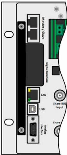
Abdeckung des Schnittstellenslots entfernen. Eventuell einen Schraubendreher zu Hilfe nehmen.
