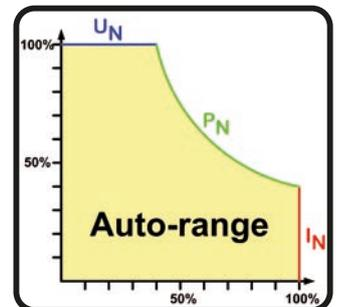
Konstantleistungsbetrieb wirkt auf den internen Stromsollwert ein. Das bedeutet, der als maximal eingestellte Strom kann unter Umständen nicht erreicht werden, wenn der Leistungssollwert nach  $I = P / U$  einen geringeren Strom ergibt und auf diesen begrenzt. Der vom Anwender eingestellte und auf dem Display angezeigte Stromsollwert ist stets nur eine obere Grenze.
