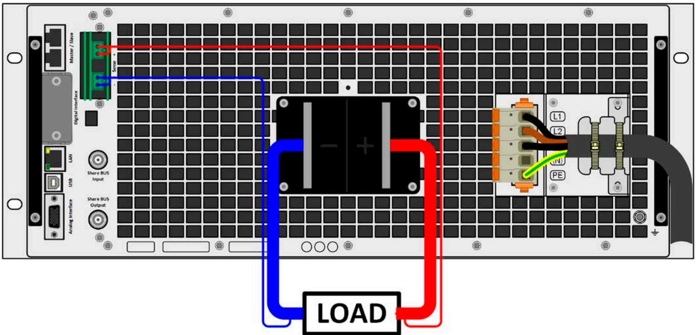
Bild 13 - Beispiel Fernfühlungsverdrahtung (DC- und Sense-Abdeckungen zu Zwecken der Veranschaulichung weggelassen)
