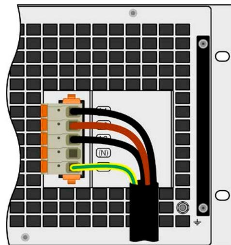
Bild 9 - Beispiel für ein Netzanschlußkabel mit 4 Adern (nicht im Lieferumfang enthalten)
