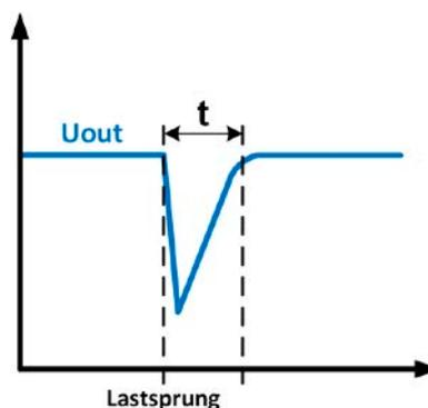
Beispiel Belastung: die Ausgangsspannung bricht kurzzeitig unter den eingestellten Wert ein.  $t$  = Ausregelzeit
