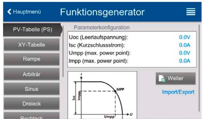
Die Spannung im MPP (hier:  $U_{MPP}$ ) liegt typisch etwa 20% unter  $U_{OC}$ , der Strom im MPP (hier:  $I_{MPP}$ ) etwa 5% unter  $I_{SC}$ . Falls keine genauen Werte vorhanden sind, können  $U_{MPP}$  und  $I_{MPP}$  dementsprechend eingestellt werden. Das Gerät begrenzt dabei die Einstellung des  $I_{MPP}$  nach oben hin auf den Wert von  $I_{SC}$ . Ebenso ist das bei  $U_{OC}$  und  $U_{MPP}$ .
