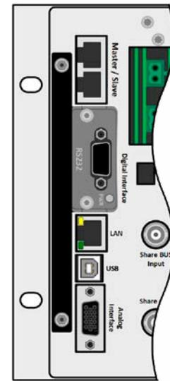
Die Schrauben (Typ: Torx 8) dienen zur Fixierung des Moduls und sollten komplett eingedreht werden. Nach der Installation ist das Modul betriebsbereit und Kabel können angeschlossen werden.
