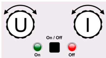
Die physikalischen Einheiten auf den Knöpfen zeigen die Zuordnung an. Der linke Drehknopf ist bei einem Netzgerät unveränderlich der Spannung U zugewiesen. Der rechte Drehknopf kann durch Antippen der Grafik auf dem Touchscreen umgeschaltet werden.
