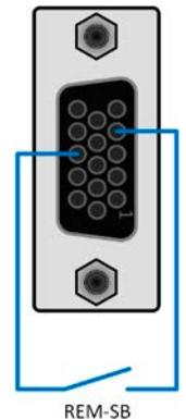
Es wird empfohlen, einen niederohmigen Kontakt wie einen Schalter, ein Relais oder Transistor zum Schalten des Pins gegen Masse (DGND) zu benutzen.
