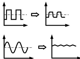
Der am DC-Ausgang resultierende Kurvenverlauf hängt dabei stark von Frequenz bzw. Periode, generierter Signalform, Amplitude und der Ausgangskapazität ab. Die Auswirkungen der Leistungsstufen können nur teilweise kompensiert werden. So kann eine zusätzliche Last (fest & ohmsch oder elektronisch & variabel) zu der eigentlichen am DC-Ausgang die Abfallzeit beim Signalverlauf signifikant verbessern.
