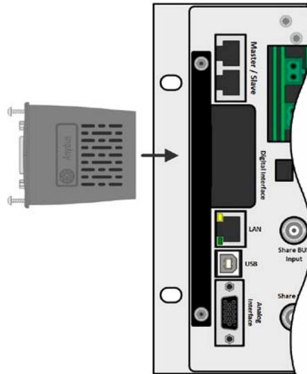
Schnittstellen-Modul paßgerecht in den Slot schieben. Es kann aufgrund der Bauform nicht falsch herum gesteckt werden.
