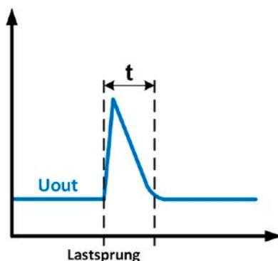
Beispiel Entlastung: die Ausgangsspannung steigt kurzzeitig über den eingestellten Wert.  $t$  = Ausregelzeit
