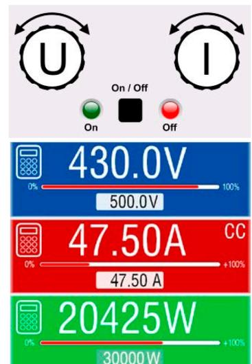
Je nach getroffener Wahl wird dem rechten Drehknopf ein anderer Sollwert zum Einstellen zugeordnet, während der linke Drehknopf immer die Spannung stellt.
