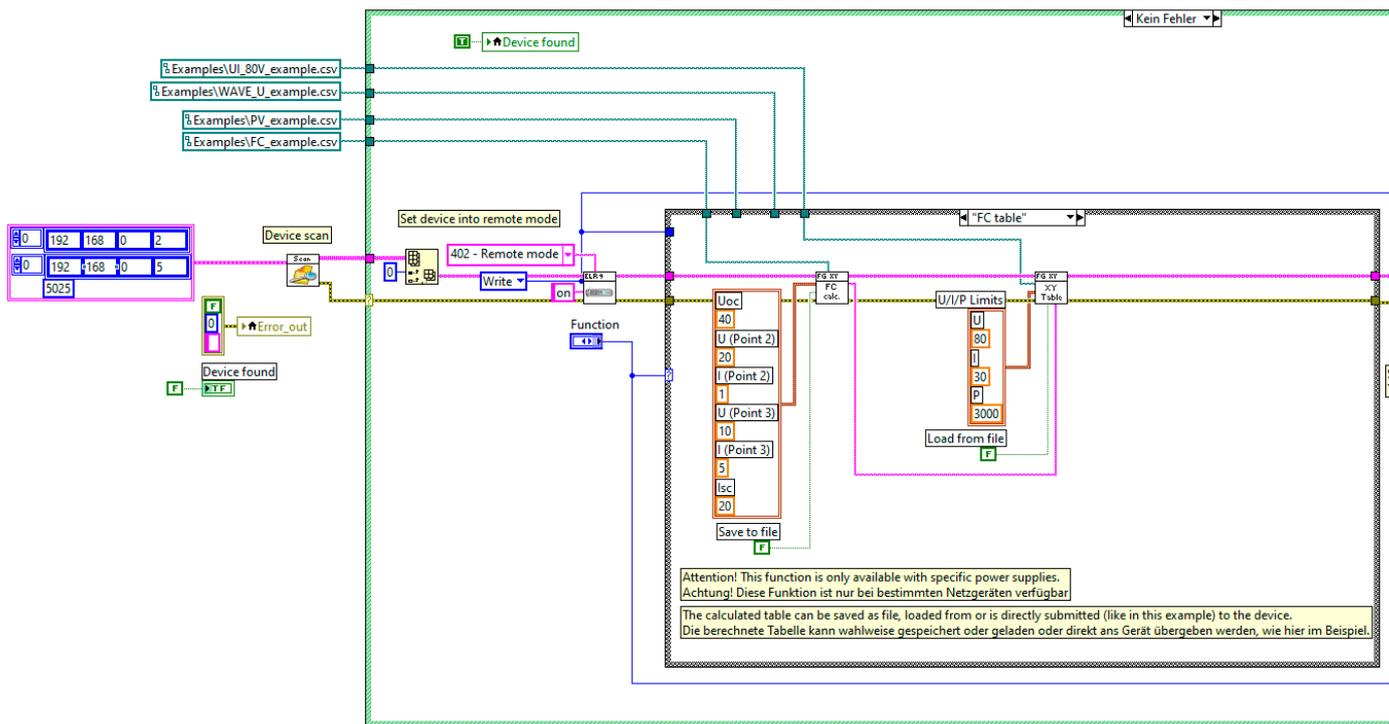
Abbildung 8: Blockdiagramm-Auszug des Beispiel-VIs zum Funktionsgenerator
