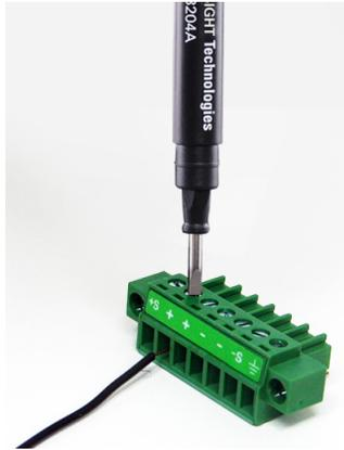
Verwenden Sie die Abschirmung nicht als Abtastleiter. Erden Sie die Abschirmung nur am Ende des U3606B. Das andere Ende der Abschirmung sollte unverbunden bleiben. Beobachten Sie die Polarität beim Verbinden der Abtastleitungen mit der Last. Sie können die Ausgangslasten mit beiden Anschlüssen (+ oder -) verbinden. Sie sind innen kurzgeschlossen.
