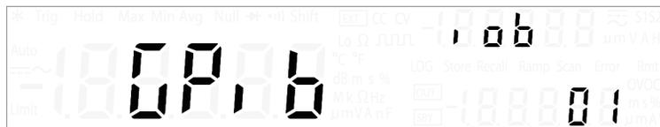
Drücken Sie auf [ $\Delta$ ] oder [ $\nabla$ ], um die Remote-Schnittstellenverbindung zu ändern (GPIb, U-CdC oder U-tMC).
