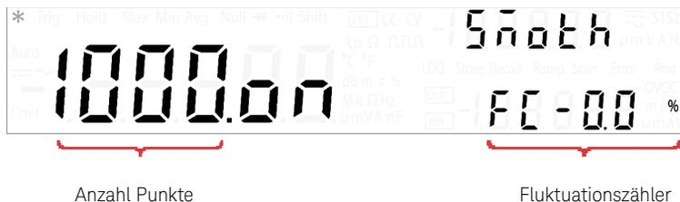
Sie stellen den Fluktuationszähler ein, indem Sie [▶] drücken, bis sich der Cursor auf der Fluktuationszahl auf der Sekundäranzeige befindet. Drücken Sie [◀] oder [▶], um die Cursorposition zu ändern, und [▲] oder [▼], um den Wert des Fluktuationszählers zu ändern. (0,0% bis 9,9%)
