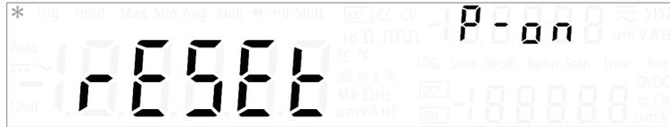
Gehen Sie wie folgt vor, um die Funktion zum automatischen Abrufen des Ausschaltstatus zu aktivieren oder zu deaktivieren, wenn das Netzteil eingeschaltet ist. Informationen zu dem Remoteschnittstellenbefehl `MEMory:STATe:RECa11:AUTO` finden Sie in der *U3606B Programmer's Reference*.
