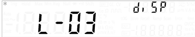
Drücken Sie auf [ $\Delta$ ] oder [ $\nabla$ ], um zwischen den verfügbaren Helligkeitsstufen zu wechseln (L-01, L-02 oder L-03).
