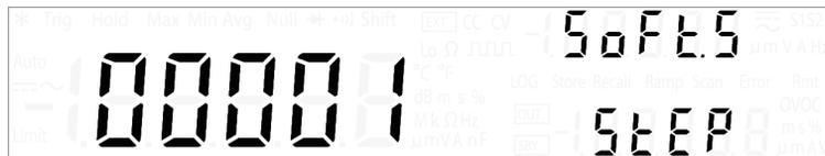
Mit dem U3606B haben Sie die Möglichkeit eines Soft-Starts der Wechselstromversorgung. Sie können einen Wert von 1 bis 10000 Schritten für den Soft-Start-Ausgang bestimmen. Diese Funktion ist zum Starten eines Gleichstrommotors zu empfehlen. Standardgemäß ist der Wert des Soft-Start-Schritts 1.
