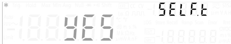
Drücken Sie auf [ $\Delta$ ] oder [ $\nabla$ ], um „YES“ auszuwählen, und drücken Sie dann auf [**Shift**] > [**Save**], um zu speichern. Das Instrument schließt automatisch das Utility-Menü und führt den Selbsttest aus.
