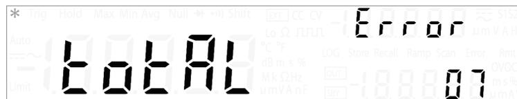
Die Fehler werden in der Reihenfolge ihres Auftretens in der Fehlerschlange nummeriert und gespeichert.
