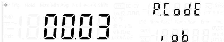
Drücken Sie auf [ $\Delta$ ] oder [ $\nabla$ ], um zwischen den Programmcoderevisionen Schnittstellenplatine (IOb), Quellplatine (Sb) und Messplatine (Mb) zu wechseln.
