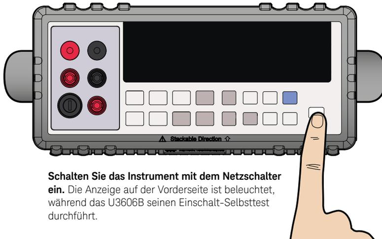
**Schalten Sie das Instrument mit dem Netzschalter ein.** Die Anzeige auf der Vorderseite ist beleuchtet, während das U3606B seinen Einschalt-Selbsttest durchführt.
