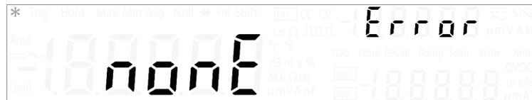
Wenn sich keine Fehler in der Fehlerschlange befinden, wird in der Primäranzeige „nonE“ angezeigt.
