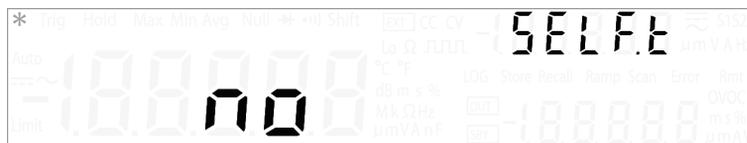
Ein Selbsttest beim Einschalten findet automatisch bei jedem Einschalten des Instruments statt. Dieser begrenzte Test stellt sicher, dass das U3606B einsatzbereit ist.
