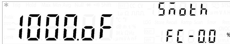
Die Glättungsfunktion ist eine spezielle Kurzzeit-Mittelungsfunktion, die sich von der Mittelungsfunktion des MinMax-Betriebs unterscheidet. Die Glättungsfunktion filtert Rauschen und stabilisiert Messwerte. Die Mittelungsfunktion des MinMax-Betriebs wird als Langzeit-Mittelungsfunktion betrachtet, weil sie alle Messwerte zur Mittelung heranzieht.
