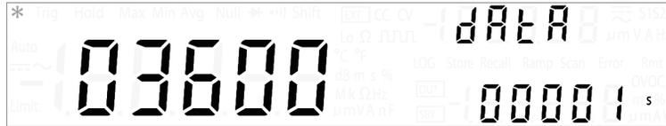
Die Datenprotokollierungsfunktion ermöglicht es Ihnen, Testdaten aufzuzeichnen und später zu prüfen oder zu analysieren. Da Daten im nichtflüchtigen Speicher gespeichert werden, bleiben die Daten auch dann gesichert, wenn das U3606B ausgeschaltet wird.
