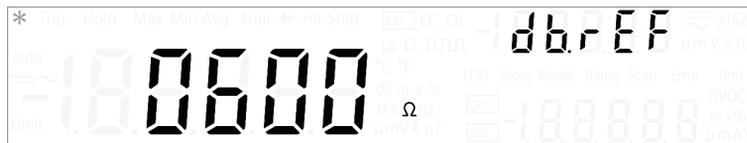
Die dBm-Funktion ist logarithmisch und basiert auf der Berechnung der Spannung, die an einem Bezugswiderstand relativ zu 1 mW erzeugt wird. Gehen Sie wie folgt vor, um einen geeigneten dBm-Referenzwiderstandswert auszuwählen. Der werkseitige, standardmäßige dBm-Referenzwiderstandswert lautet 600  $\Omega$ .
