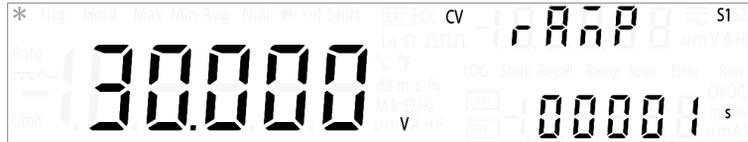
Drücken Sie auf **[Voltage]** oder **[Current]**, wenn Sie die Abtastsignalparameter für CV- oder CC-Ausgabe konfigurieren möchten.
