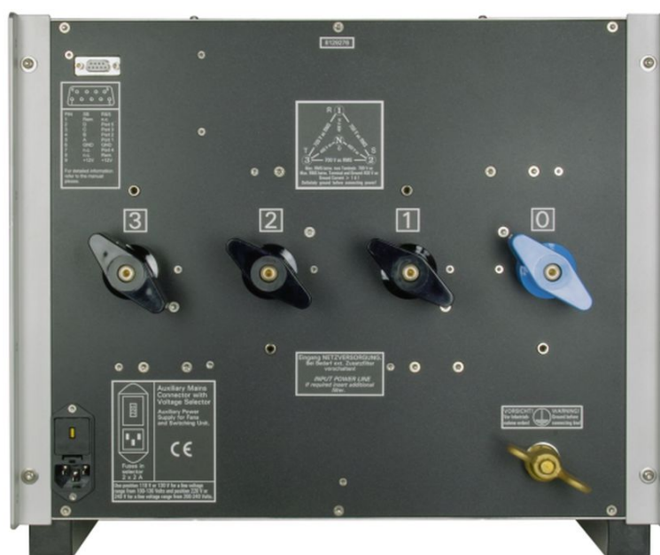
Abb. 2: NSLK 8129 mit Optionen RC und Lüfter Fig. 2: NSLK 8129 with options RC and fans
