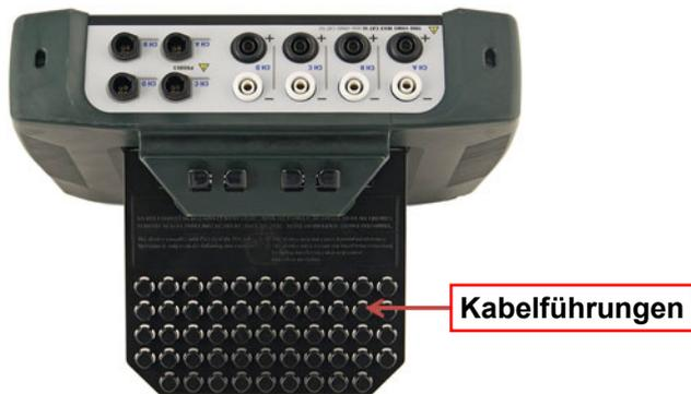
Die Kabelzugentlastung verhindert darüber hinaus, dass das 12-V-Kabel bei laufender Messung unbeabsichtigt abgezogen werden kann.
