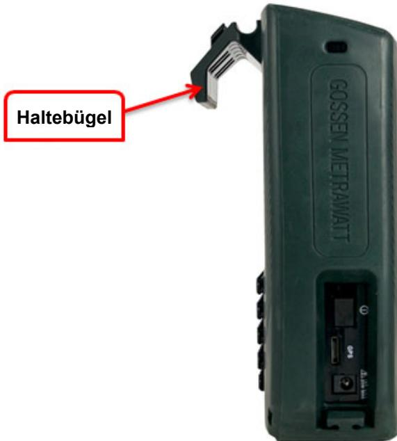
Die Gehäuse bieten verschiedene Möglichkeiten zur übersichtlichen und sicheren Befestigung aller Messkabel am Gerät. Am Haltebügel auf der Gehäuserückseite befinden sich Kabelführungen, zusätzlich ist in die Rückwand eine ausklappbare Kabelführungsplatte integriert.
