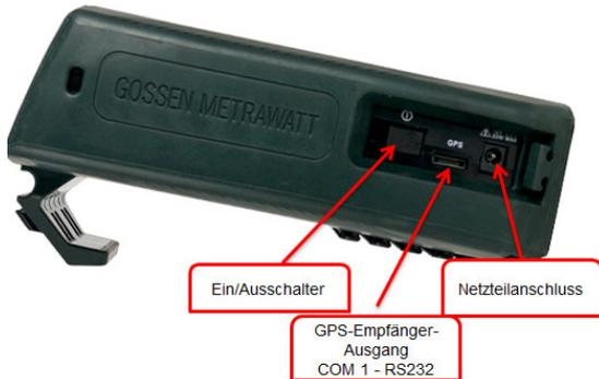
Stromversorgung über 12-V-Netzteil, Eingangsspannung 90 ... 265 V AC, 50/60 Hz. Anschlussstecker nach US-, UK-, Euro- und Australien-Standard im Lieferumfang enthalten. Ein austauschbarer NiMH-Akku (USV) ist im Lieferumfang enthalten. Laufzeit nach Vollladung: zwei Stunden (MAVOWATT230 & 240: drei Stunden). Die Ladezeit bei leerem Akku beträgt drei Stunden.
