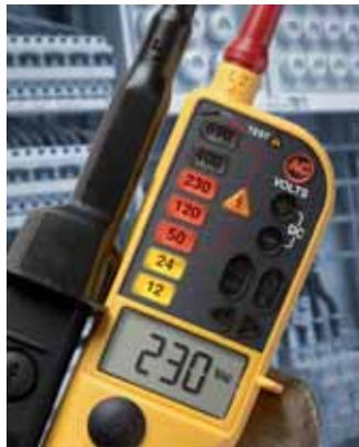
Meldungen mit vier verschiedenartigen Spannungsanzeigen: Eine klare Darstellung von Status und Messwerten über LEDs, die Anzeige des Messwertes auf der hellen Digitalanzeige, Durchgangstest mit akustischem Signal oder ein Vibrationsgeber, der eine fühlbare Rückmeldung gibt (Vibrationsgeber in T110, T130, T150). Abhängig von der jeweiligen Situation können Sie die jeweils effektivste Methode auswählen.
