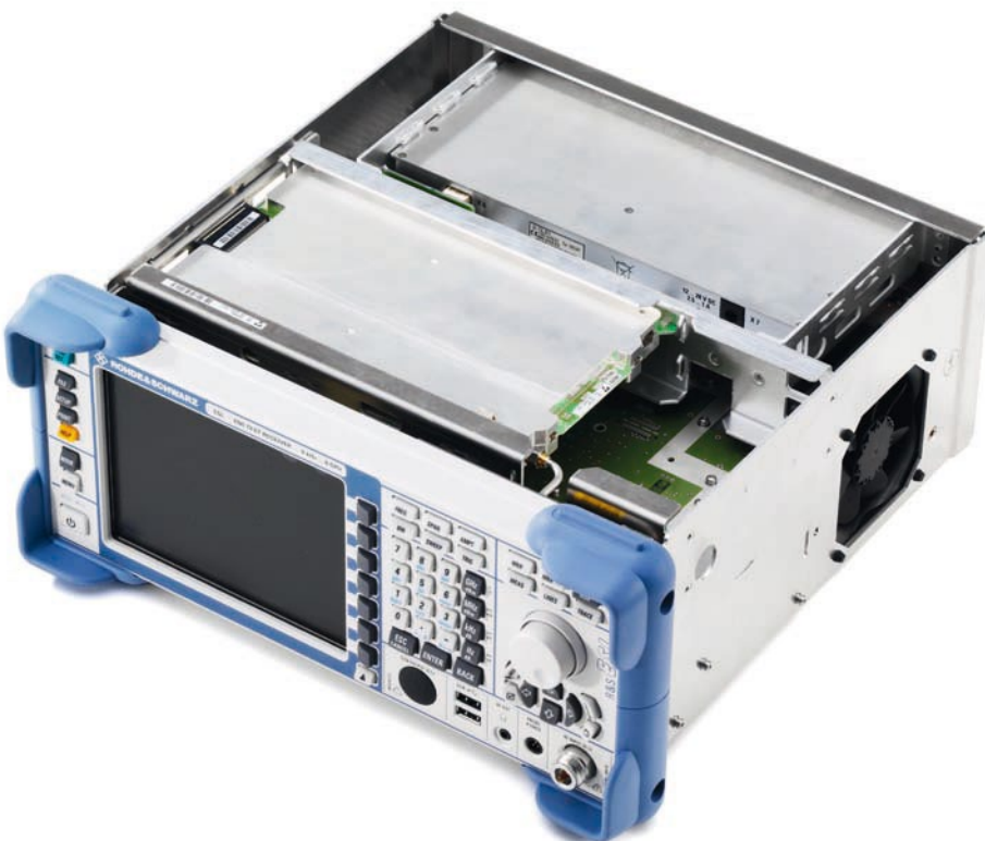
Der Innenaufbau des R&S®ESL
