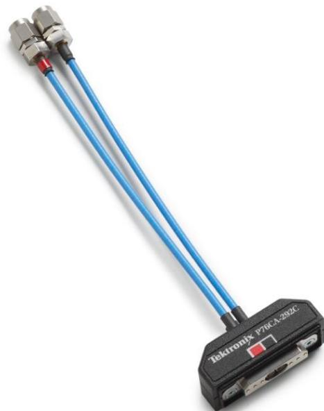
Koaxialadapter mit 33 GHz Bandbreite mit 2,92 mm-Steckern und 6 Zoll-Hochleistungskabel. Dieser Adapter wird an den Eingangsanschlüssen kalibriert und eignet sich perfekt für die direkte Verbindung mit Geräten mit 2,92 mm- oder SMA-Ausgangsanschlüssen.
