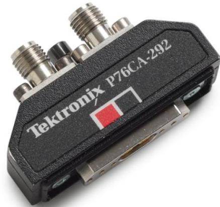
Koaxialadapter mit 33 GHz Bandbreite mit 2,92 mm-Steckbuchsen. Dieser Adapter wird an den Eingangsanschlüssen kalibriert und eignet sich perfekt für die Verwendung mit handelsüblichen oder benutzerdefinierten Kabeln. Um die vollständige Bandbreitenleistung aufrechtzuerhalten, sollten Kabelpaare mit geringem Versatz verwendet werden.
