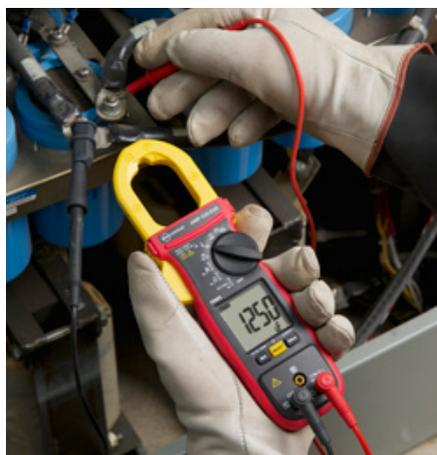
AMP-320-EUR Gleich-/Wechselstrommesszange, Instandhaltung elektrischer Motoren
