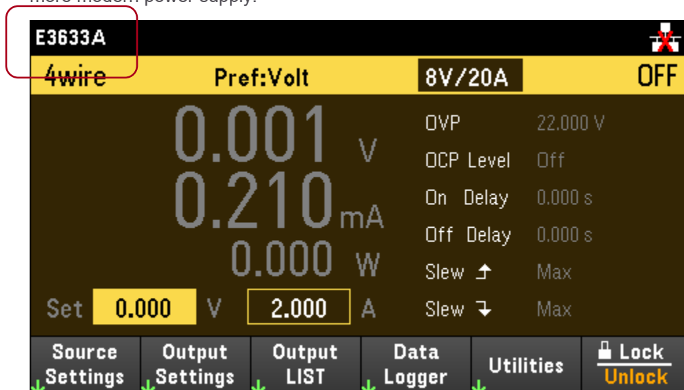
Figure 6. Enable E3633A/E3634A mode on the E36231A and E36232A
