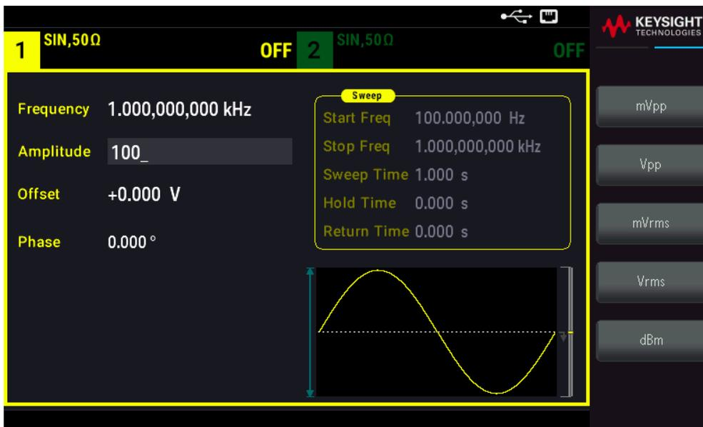
Pour utiliser un niveau élevé et un niveau faible à la place : Appuyez sur [Units] > Ampl/Offs | [High/Low](#).
