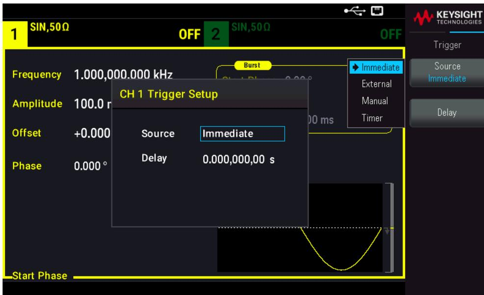
Pour spécifier si l'instrument se déclenche sur un front montant ou descendant du signal sur le connecteur **Ext Trig**, sélectionnez la source de déclenchement externe avant de choisir **Trigger Setup**.
