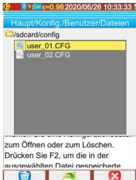
Abrufen einer Setup-Datei: Aus dem Hauptmenü / Konfiguration / Benutzer / Datei über den Dateimanager, der alle im Verzeichnis « /media/sdcard/config/ » gefundenen Konfigurationsdateien enthält (Erweiterung .cfg).
