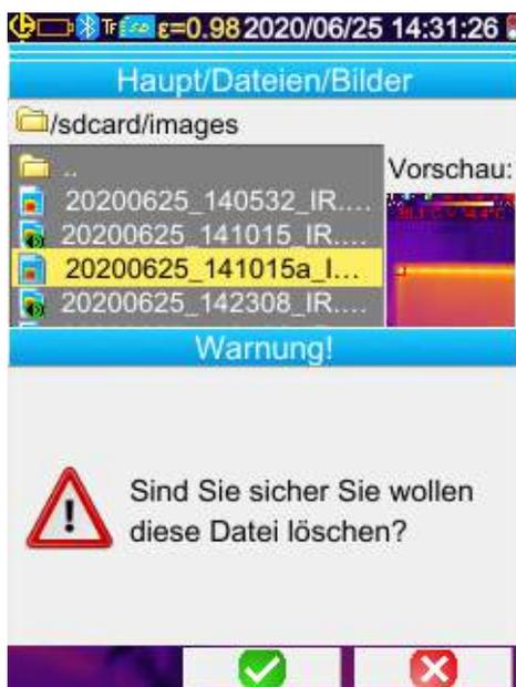
Bilder werden im Dateimanager (Hauptmenü/Dateien/Bilder) mit der Taste **F1**
