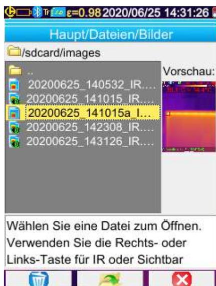
Der Dateimanager listet nur Infrarot-Bilder der Kamera auf, die mit einem Namen wie zum Beispiel jjjmmmtt\_hhmmssX\_IR.PNG generiert wurden, sowie die Ordner, um ein Verschieben im Navigationsbaum der SD-Karte zu ermöglichen.
