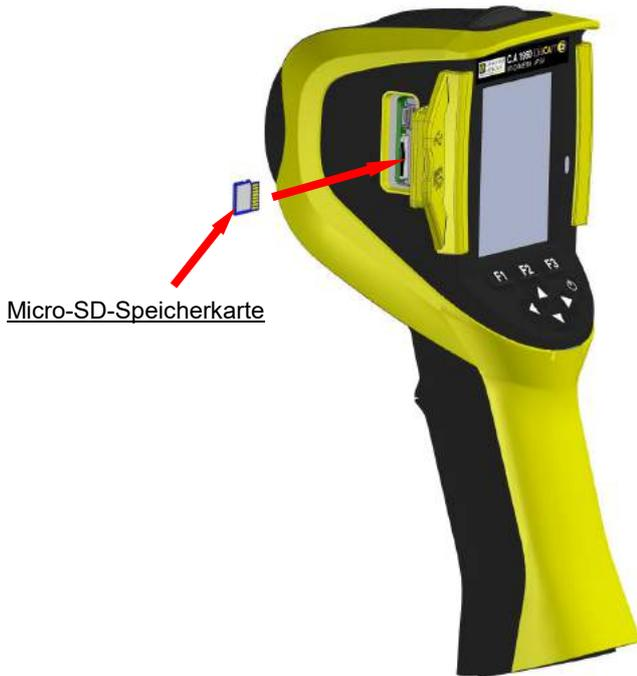
Dateien, die von der Kamera erstellt werden (Bilder, Tondateien und Konfiguration), nur auf der Micro-SD-Speicherkarte abgespeichert. Diese befindet sich auf der linken Seite des Kopfes.
