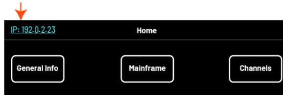
2. Die aktuelle LAN-Konfiguration wird angezeigt. Wählen Sie **Konfiguration**, um weitere LAN-Einstellungen anzuzeigen.
